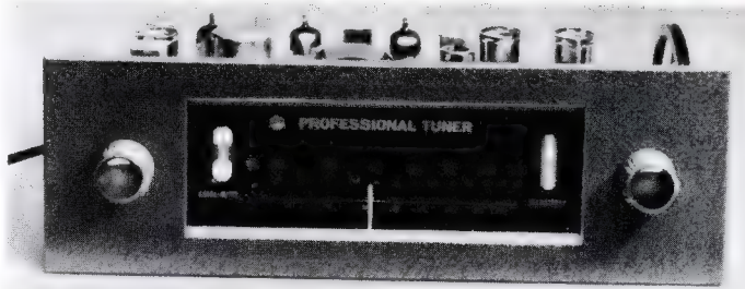
Bild 1. Ansicht des Professional-Tuners von Kurt Gabler, Zürich; jede Skala wird individuell von 88 bis 100 MHz geeicht
