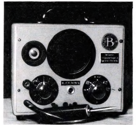
Bild 2. Gerät und Tastkopf des Bellophon-Signalverfolgers
